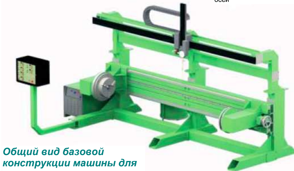
Оси перемещения оснащены датчиком положения для обеспечения точности и воспроизводимости результатов перемещения; улучшенная синхронизация осей
